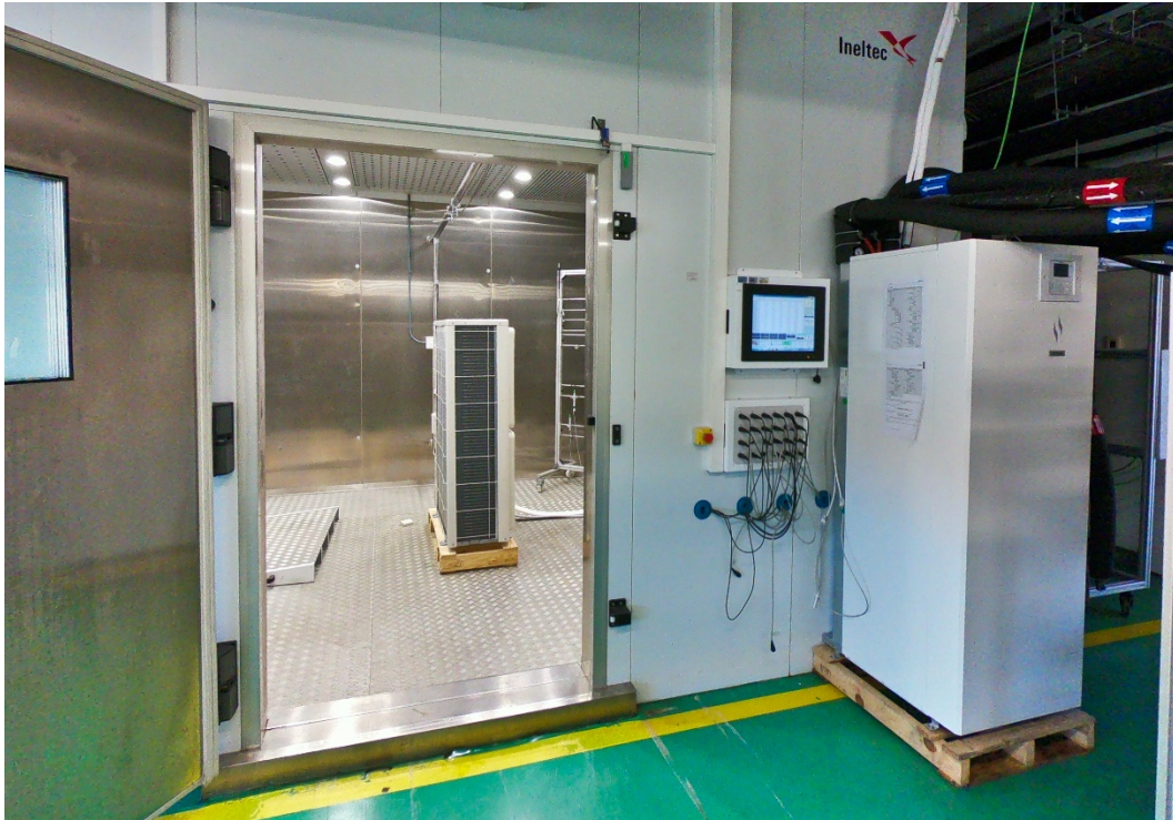
Figura 11. Instal·lació de la bomba de calor en el laboratori: unitat exterior dins de la cambra climàtica, unitat interior amb tanc integrat fora de la cambra climàtica
